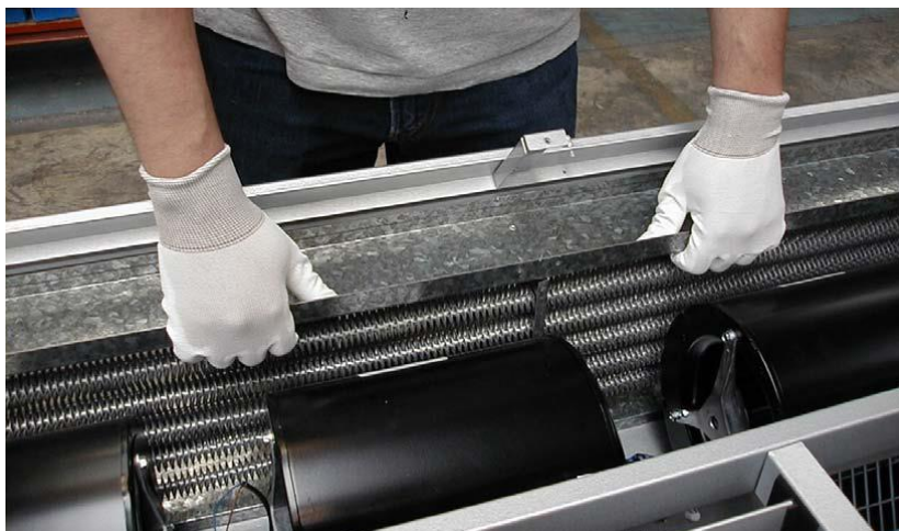
5. Wyjąć nagrzewnicę używając rękawiczek, aby ochronić dłonie przed skaleczeniem.
