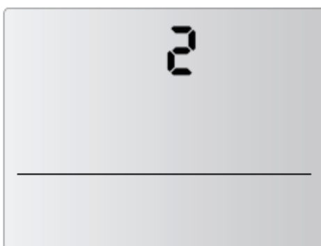
2 jednostki podłączone—ostatni wyświetlony numer podczas inicjalizacji.
